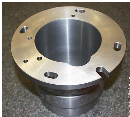
Genauste Innenpassungen mit Toleranzen im \mu -Bereich sind schwierig zu fertigen, aber lösbar.
